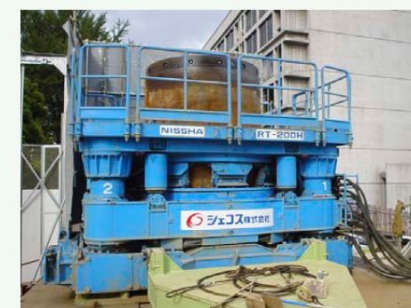
全回転オールケーシング工法
